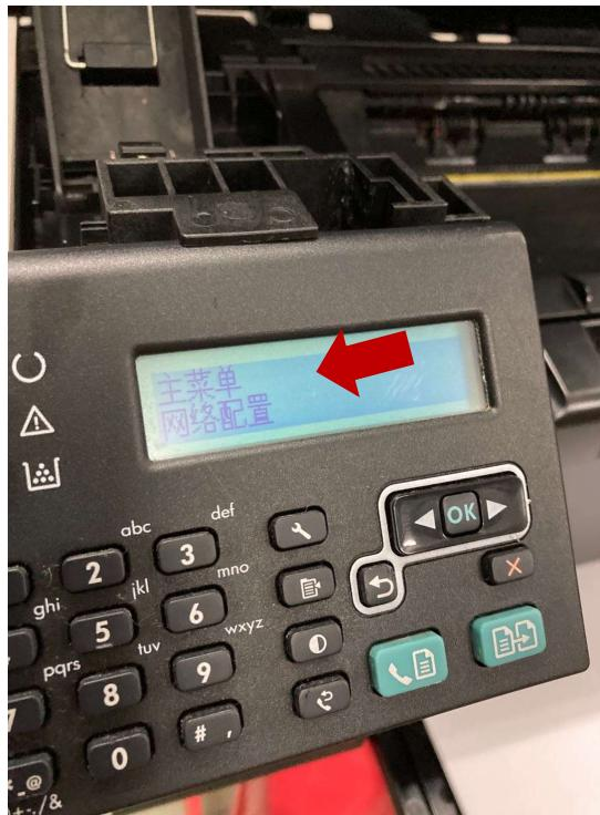
第4步: 继续按右键, 找到TCP配置, 此时为自动 (Automatic) 获取IP。如果要配置为指定IP, 轻按一次OK, 再次按右键, 显示为手动 (Manual), 即可按需要配置IP地址。
